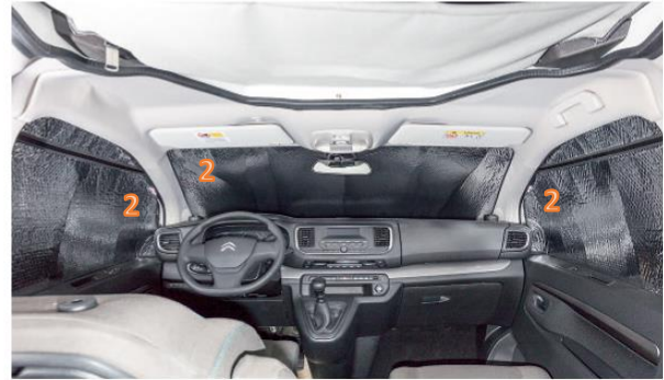
Unten wird die ISOLITE-Matte in den Spalt zwischen Glasscheibe und Armaturentafel geschoben.
