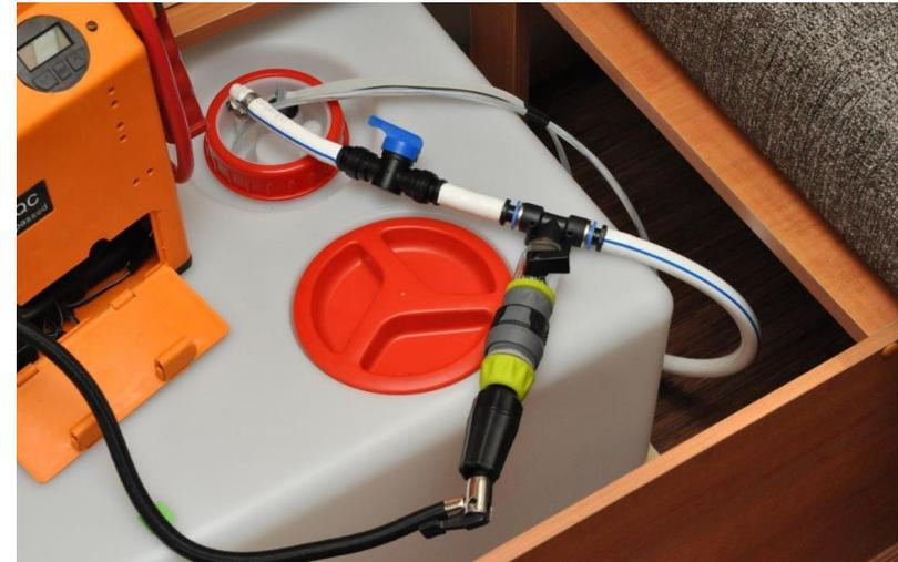
Die Verbindung zum Frischwassertank wird geschlossen und das Leitungssystem unter Luftdruck gesetzt. Danach werden alle Hähne geöffnet bis kein Wasser mehr austritt.
