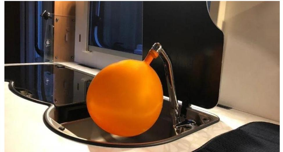
Lassen Sie nun alle Wasserhähne bis zur nächsten Inbetriebnahme des Wassersystems auf der Mittelposition geöffnet.
